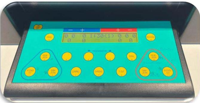
Cet appareil portable, d'un poids de cinq kilogrammes, est connecté à des manettes permettant aux juges de coin de consigner les coups valides, qu'il s'agisse de coups de poing ou de pied portés à la tête ou au plastron. Un signal sonore vient marquer la fin du temps réglementaire, tandis que l'écran associé assure le suivi en temps réel du score.
